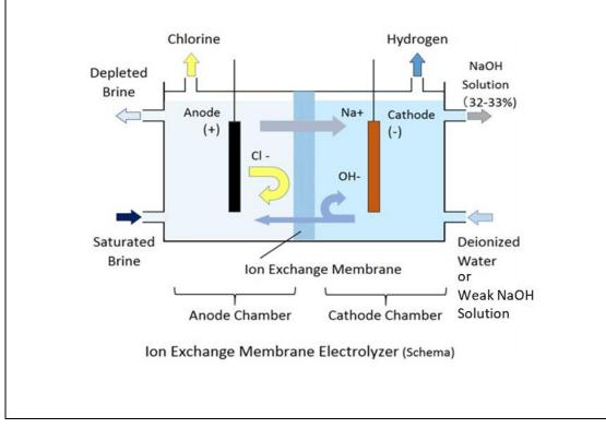
$2NaCl + 2H_2O \quad \rightarrow \quad 2NaOH + Cl_2 + H_2$
